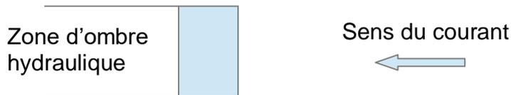
Zone située à l'arrière d'un bâtiment ou ouvrage existant par rapport au sens du courant. Le fait d'implanter un bâtiment dans l'ombre hydraulique d'un autre bâtiment limite son effet d'obstacle à l'écoulement.
